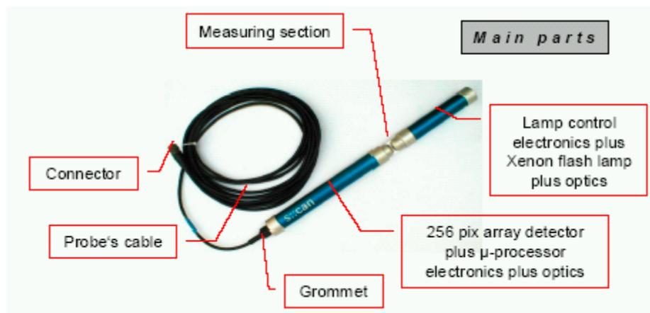
Figure 2.1: The Spectro::lyser probe.
